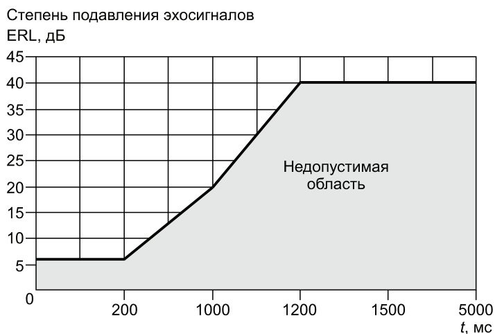
Рисунок 8 — Зависимость степени подавления эхо-сигналов ERL от времени
