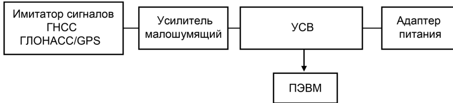
Рисунок В.1 — Схема испытательного стенда
