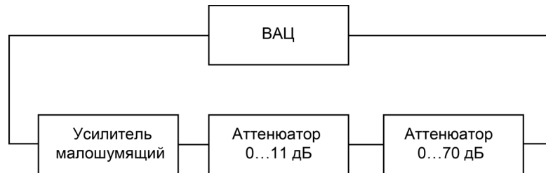
Рисунок В.2 — Схема калибровки тракта
