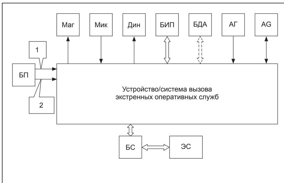
Маг — магнитола АТС; Мик — микрофон; Дин — динамик; БИП — блок интерфейса пользователя; БДА — блок датчика аварии; АГ — антенна ГЛОНАСС; АГ — антенна GSM/UMTS; БП — блок питания (12/24 В); БС — блок сопряжения; ЭС — эмулятор системы экстренного реагирования при авариях; 1 — кабель питания; 2 — цепь зажигания
