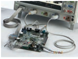
При разработке схем с использованием ПЛИС компаний Altera или Xilinx рекомендуется использовать динамический пробник ПЛИС
