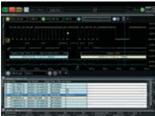
Три прибора в одном: осциллограф, логический анализатор, анализатор протоколов
