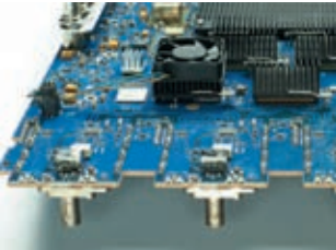
Малошумящие входные каскады и корректирующие фильтры обеспечивают равномерную частотную характеристику
