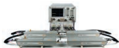
Система миллиметрового диапазона N5251A с единым циклом свипирования от 10 МГц до 110 ГГц
