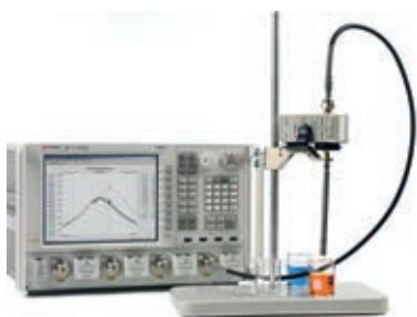
Система миллиметрового диапазона N5251A с единым циклом свипирования от 10 МГц до 110 ГГц
