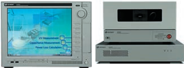
B1507A имеет в своём составе базовый блок (слева), тестовое устройство подключения (справа), соединительные кабели и управляющее программное обеспечение
